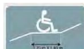
Pente transversale : le devers doit être inférieur à 2 %
