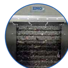
2 Tapis de déchets constitué contre les lames (filtre supplémentaire)
