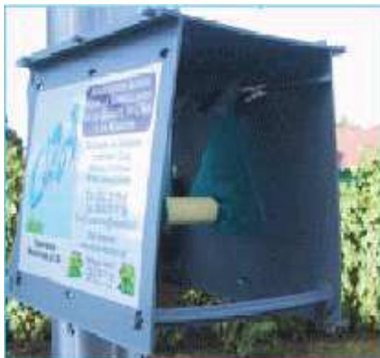
Figure 91: Abri comportant des tubes passifs installés sur un poteau (Source : Atmo Réunion)
